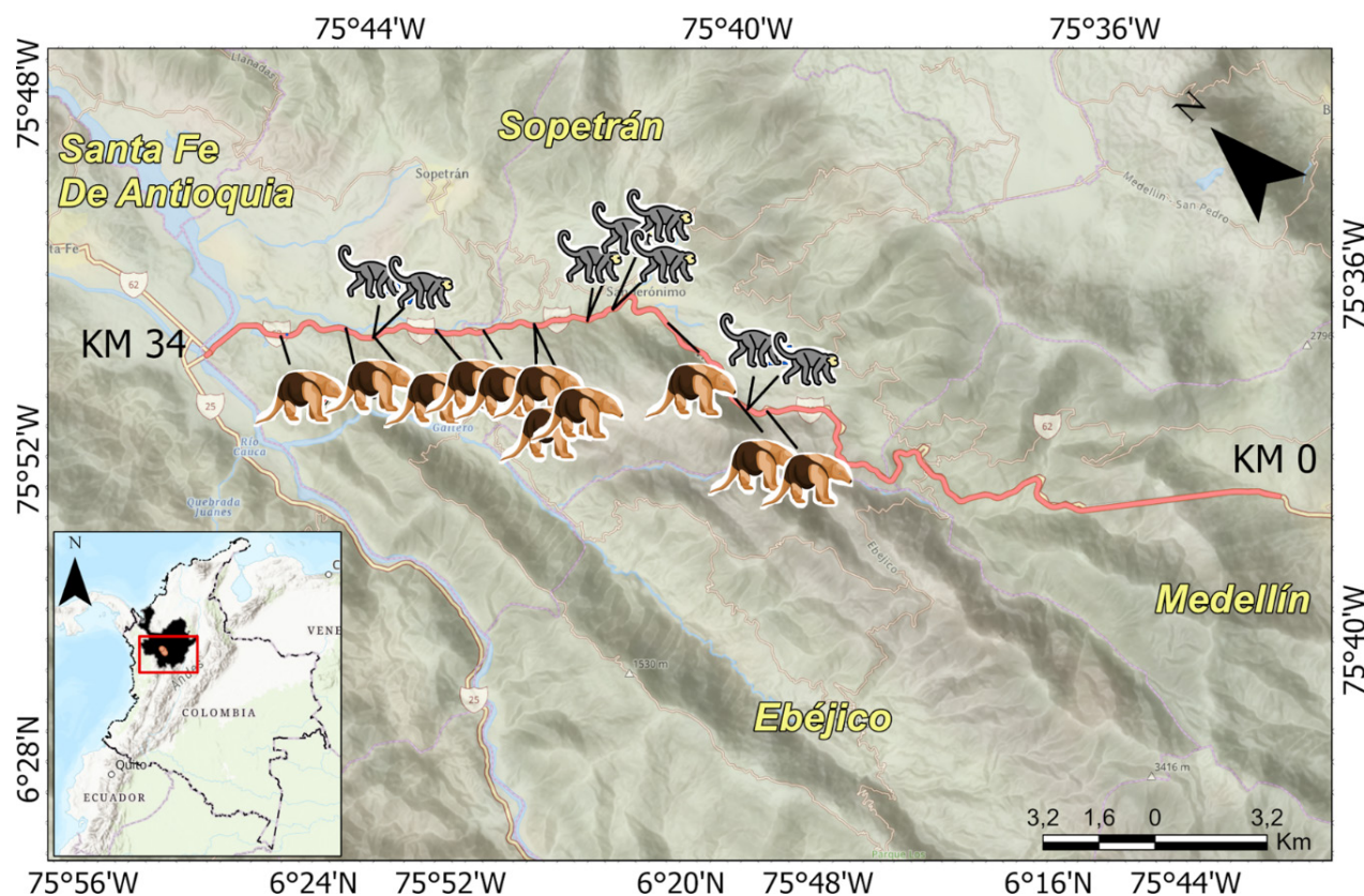
Figura 2. Localización de pasos de fauna superiores (monos) y obras hidráulicas adecuadas (oso melero) instalados en la Autopista al Mar 1
