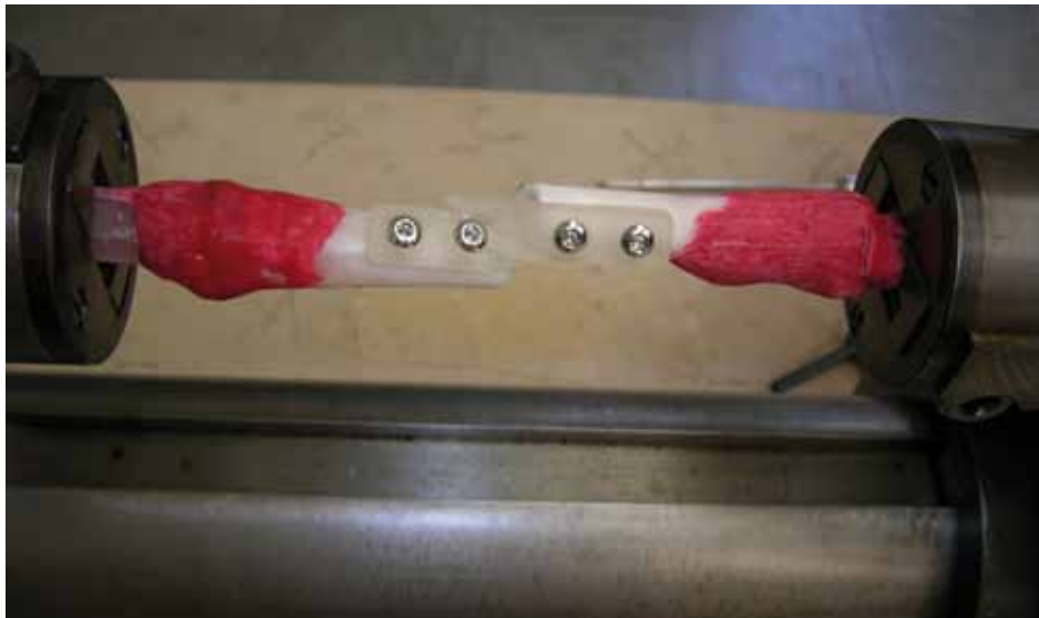
Figura 2. Placa de compresión dinámica de polimetilmetacrilato (PCD-PMMA) sometida a fuerza de rotación, con ruptura en el 2° orificio durante la evaluación de la resistencia de un prototipo de PCD-PMMA probada en fémur canino osteotomizado (n=48)
